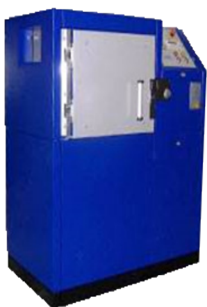
Irradiateur à chambre Source ^{137}\text{Cs}
