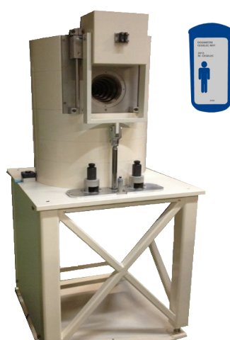
Irradiateur Multi-sources à champ externe Sources ^{60}\text{Co} et ^{137}\text{Cs}
